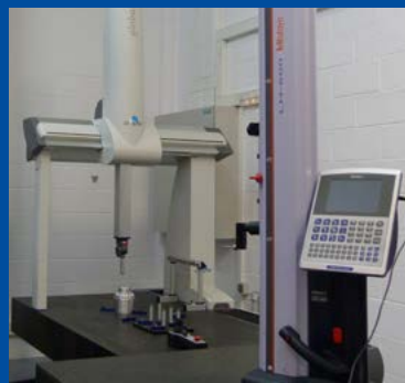
Máquina de medición por coordenadas (MMC) DEA GLOBAL PERFORMANCE 9128 equipada con cabezal TESASTAR-M y sonda de medición en continuo LEITZ LSP-X1.
