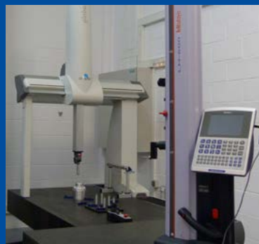
Màquina de mesura per coordenades (MMC) DEA GLOBAL PERFORMANCE 9128 equipada amb capçal TESASTAR-M i sonda de mesura en continu LEITZ LSP-X1.
