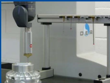
Màquina de mesura per coordenades (MMC) DEA GLOBAL PERFORMANCE 9128 equipada amb capçal TESASTAR-M i sonda de mesura en continu LEITZ LSP-X1.
